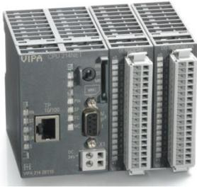
VIPA 200V模块化可编程控制器及现场总线系统是用于自动化工程领域的中小型控制系统，性能（速度和容量等）上相当于SIEMENS S7-300的中小型系统，但体积上更为紧凑，单个模块的尺寸仅为76×25.4×76mm，可直接安装在标准35mm DIN导轨上，模块间的电气连接通过嵌入导轨的背板总线V-BUS来实现，各种模块可灵活组合，构成用户所需要的应用系统，单排CPU和从站都可以直接连接最多32个模块，也可通过扩展接口模块组合成多排安装。
