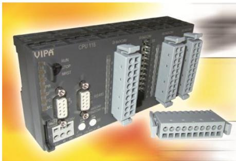
VIPA 100V紧凑型控制器及现场总线系统是应用于自动化工程领域的小型PLC系统，结构设计非常紧凑，单个模块的尺寸为76×152.4/101.6×48mm，安装在标准35mm DIN导轨上，实现微型和小型PLC的功能，是CPU与IO、从站模块与IO一体化的控制系统，并可以通过嵌入导轨的背板总线V-BUS来扩展四个100V的IO扩展模块或200V的模块，可灵活地构成用户所需要的应用系统。
